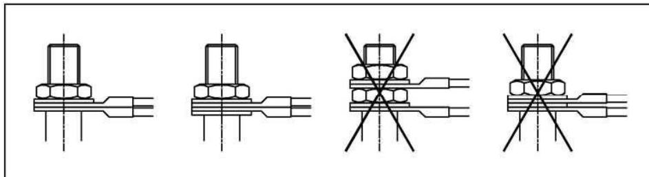
**LET OP:** De installateur moet de elektrische aansluiting en de installatie van de ventilator volgens de toepassingsomgeving in overeenstemming met de geldende normen uitvoeren (IEC 606364). Thermische beveiligingen: Controleer het type beveiling dat geïnstalleerd is alvorens de aansluiting tot stand te brengen; voor de thermistoren is een speciaal ontkoppelrelais vereist.
